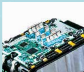
Struktur zur Verhinderung von Kurzschlüssen
